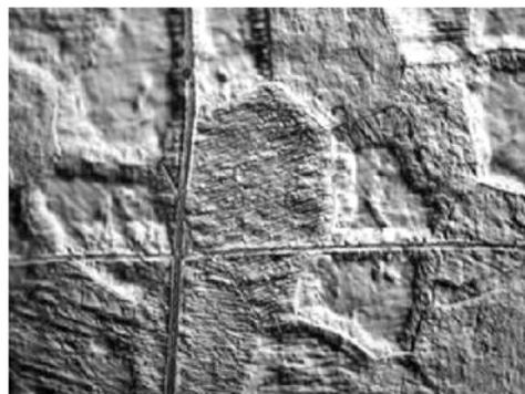
Рисунок 3 - Конгломераты зерен в Ti – H<sub>2</sub>,  $N=3,5 \times 10^7$  циклов,  $\times 550$
