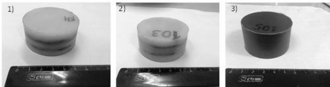
Рисунок 6 – Общий вид модельных заготовок (1 - СВМПЭ армированный стальной сеткой с крупной ячейкой, 2 - СВМПЭ армированный стальной сеткой с мелкой ячейкой, 3 - 87% СВМПЭ+13% Cu армированный стальной сеткой с мелкой ячейкой)
