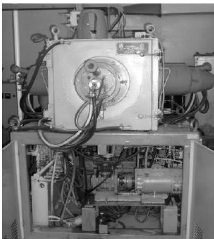
Рисунок 1 – Установка ННВ-6 «Булат»
