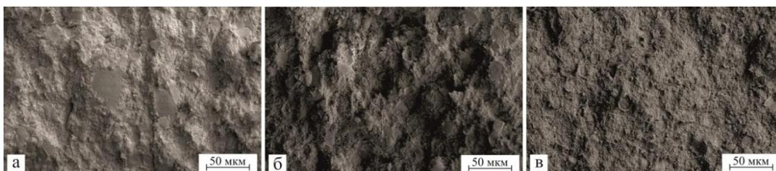
Рисунок 3 – Фрактограммы неспеченных образцов, полученных при давлении прессования 150 МПа из пресс-порошка с влажностью: а) 1 %; б) 2,5 %; в) 5,5 %
