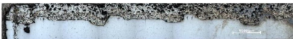
Рисунок 3 – Микроструктура напыленного покрытия на подготовленную поверхность с помощью электронно-лучевой 3D – модификации
