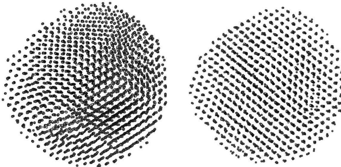
Рисунок 3 - Слева - кластер алюминия с первоначально пониженной плотностью диаметром 6 нм при  $T = 150$  К, справа – при  $T = 500$  К
