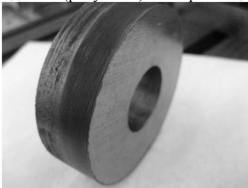
Рисунок 1 – Образец с нанесенным медным покрытием
