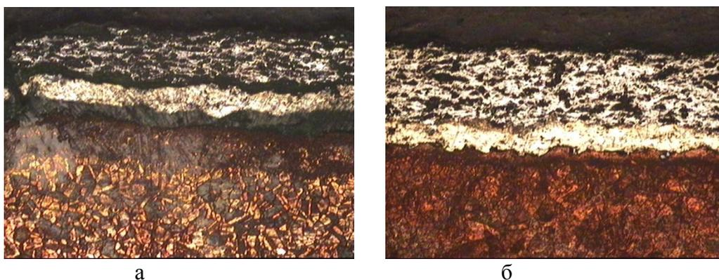
Рисунок 1 - Микроструктура покрытий состава  $\text{Al}_2\text{O}_3\text{-}20\text{мас.}\% \text{W}_2\text{N}$  (подслоя Н85Ю15); а- без оплавления; б - оплавление при  $I=24$  мА
