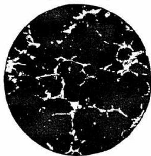
Описание. Для каждой марки стали нормальная структура характеризуется определенной (небольшой) величиной зерна. При образовании грубого зерна размер его во всем объеме или в отдельных участках существенно превышает эту величину. Поверхность разрушения имеет вид грубозернистого блестящего (кристаллического) излома. В микроструктуре при соответствующем увеличении наряду с мелкими зернами наблюдается большое число крупных зерен.
