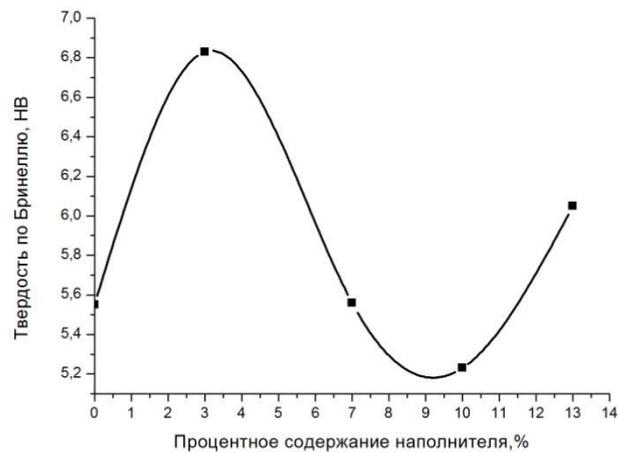
Рисунок 6- График зависимости твердости по Бринеллю от процентного содержания наполнителя в композициях
