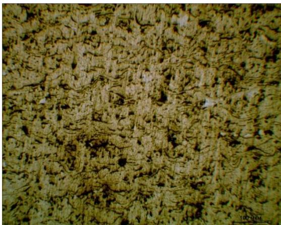
Рисунок 2- Микрошлиф пятна напыления
