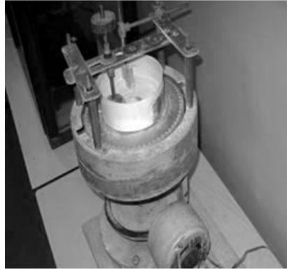
Рисунок 2- Установка для испытания износостойкости «ИИП-1»
