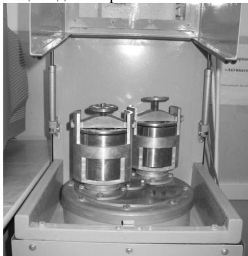
Рисунок 2 – Общий вид планетарной мельницы «Активатор 2SL»
